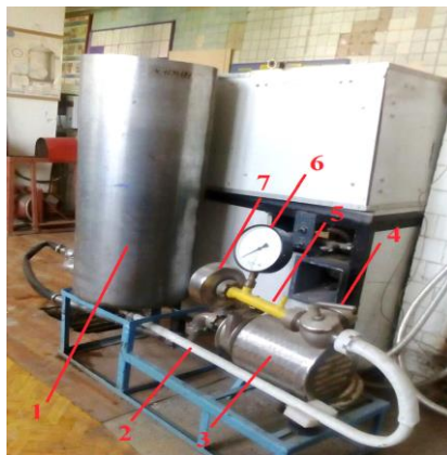
Рис. 3. Експериментальна установка: 1 – ємність з підігрівачем для води; 2 – трубопровід; 3 – насос; 4 – кран; 5 – труба з магнітом; 6 – манометр; 7 – ежектор
