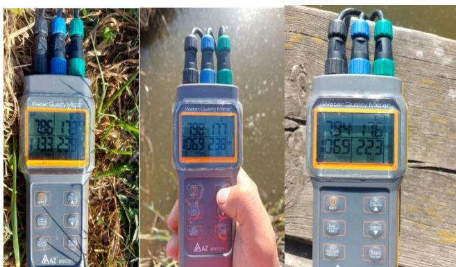
Рис. 3.1. Показники води за допомогою Water Quality Meter
