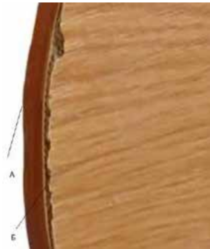
Рис. 4.2. Деформації плитних матеріалів: а – набрякання; б – сколи [43].
