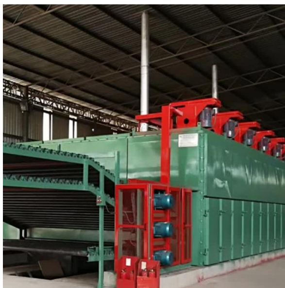
Рис. 1.13. Роликова сушарка шпону VTS-4-4200
