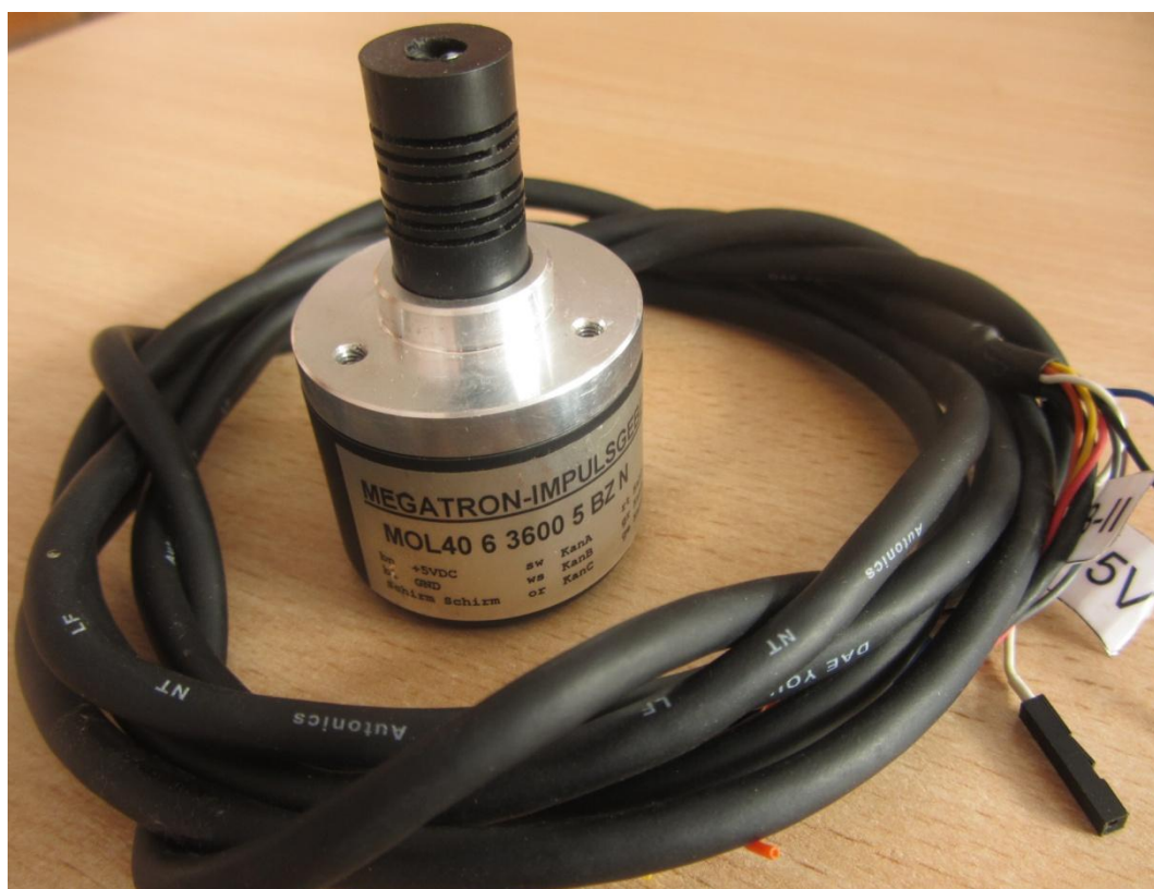
Рис. 4.13. Зовнішній вигляд енкодерів: а) ENC Autonics; б) MOL-40 Megatron
