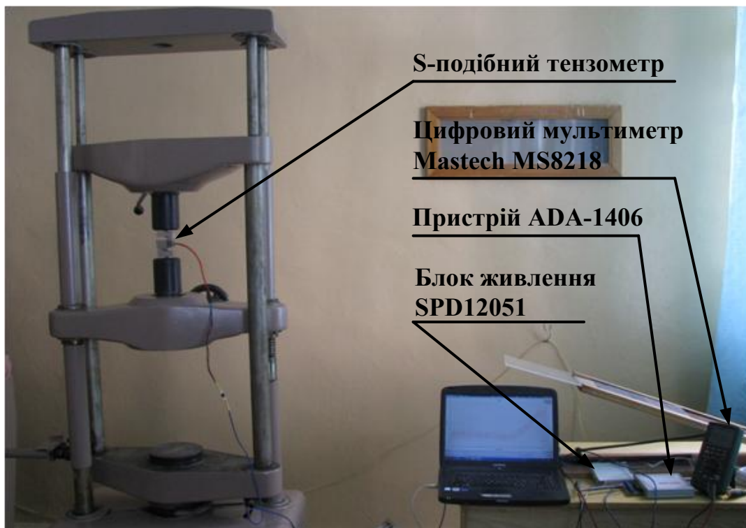
Рис. 4.9. Тарування датчика зусилля
