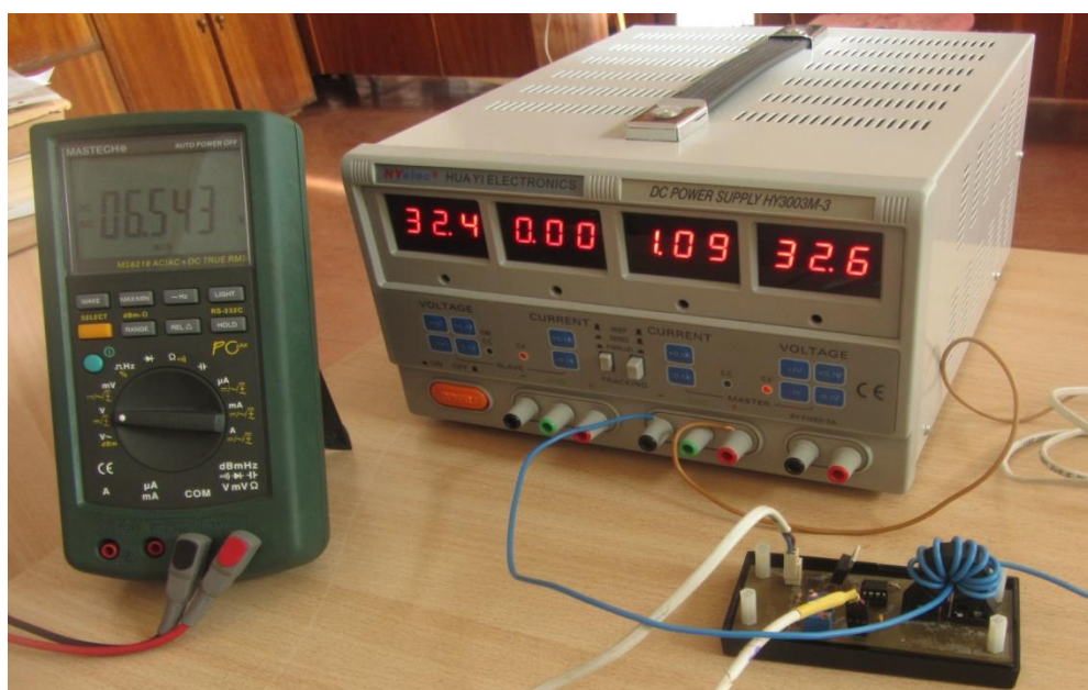
Рис. 4.7. Тарування датчика струму
