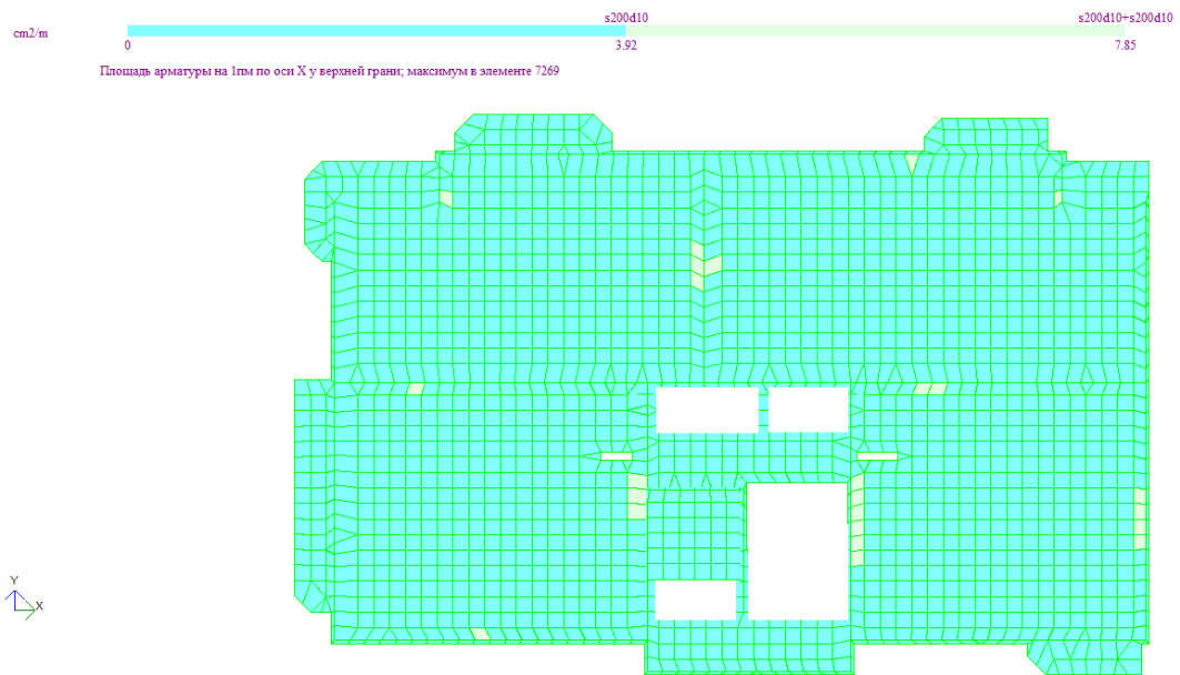
Рис. 2.8 – Верхнє армування плити перекриття по вісі X
