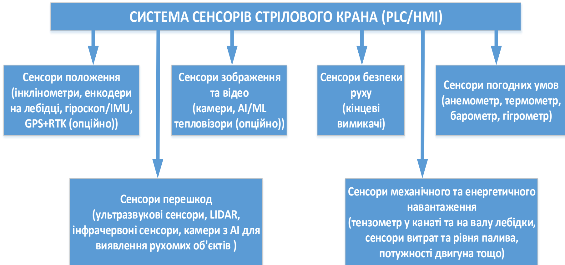
Рисунок 5.1 – Схема системи сенсорів стрілового крана
