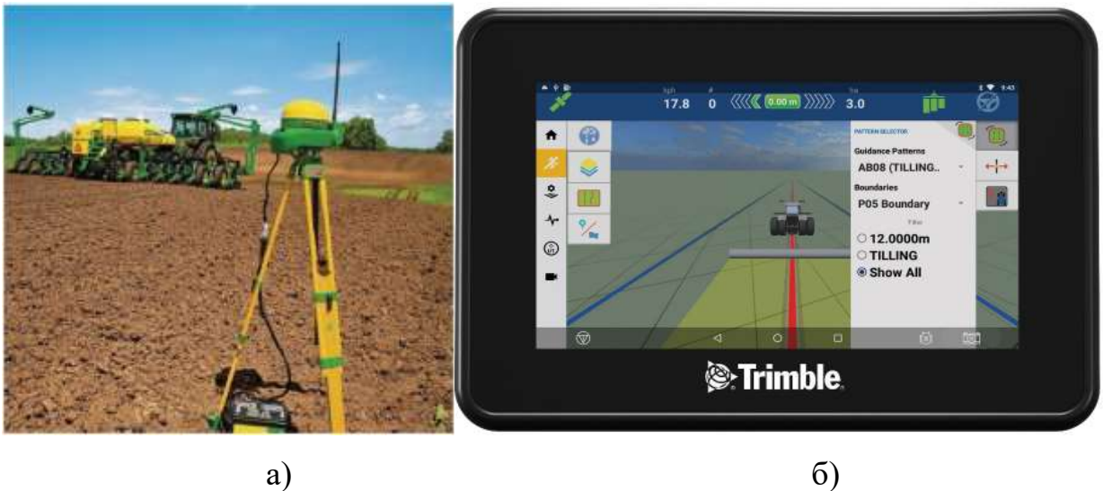
Рис. 1.5. Базова RTK-станція портативного типу, що використовується для корекції руху у системах паралельного водіння (а) та монітор Trimble з відображенням процесу паралельного водіння по рядках (лініях) (б)
