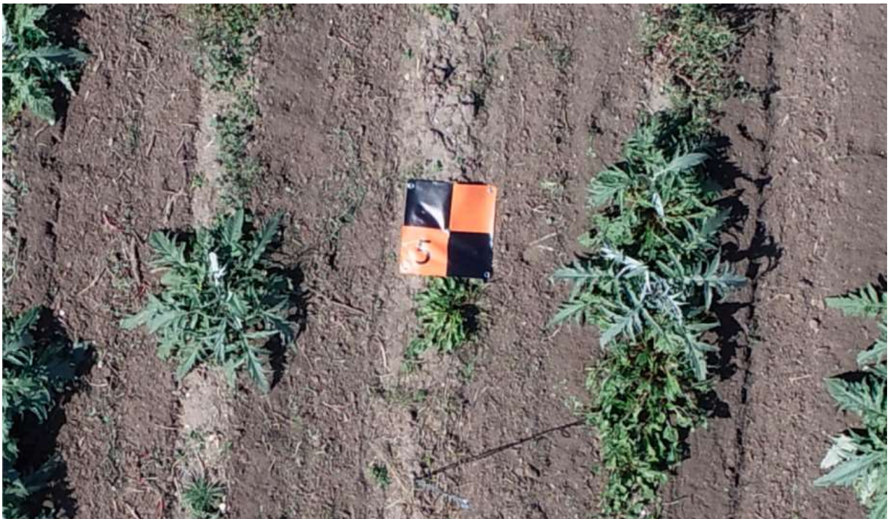
Рис. 3.8. Одна із 12 опорних точок (0,5x0,5 м), що використовуються для прив'язки зображень
