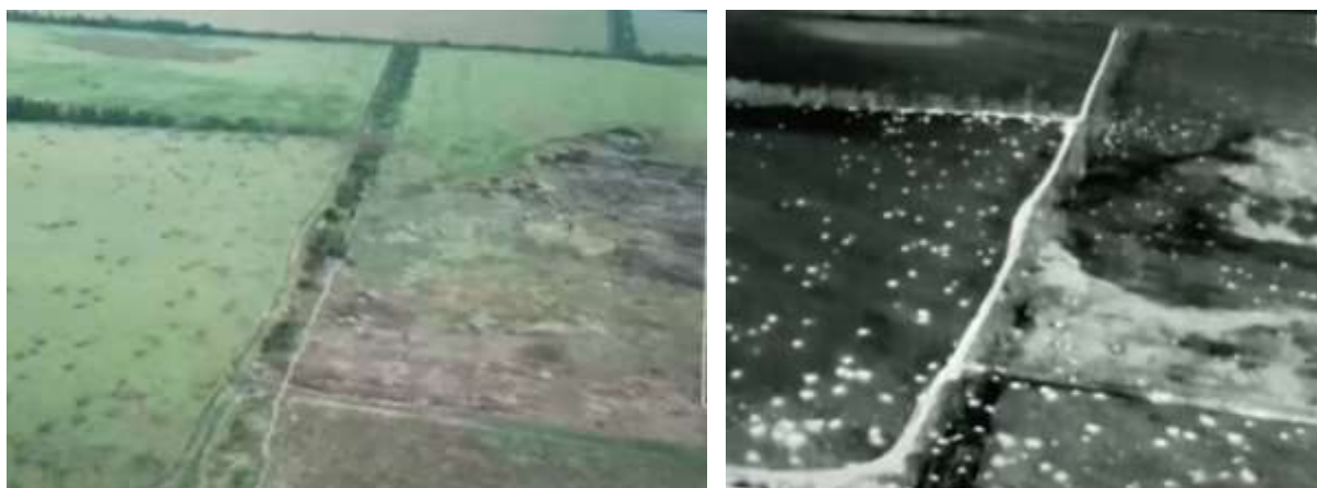
Рис. 4.4. Знімки поля із воронками від вибухів мін та снарядів у видимому та тепловізійному діапазонах спектру з ліва та праворуч відповідно. (Джерело https://sensor.net/ru/video_news/3437668/vsu_ispolzuyut_teplovizory_dlya_obnaru_jeniya_min_cnn_video )
