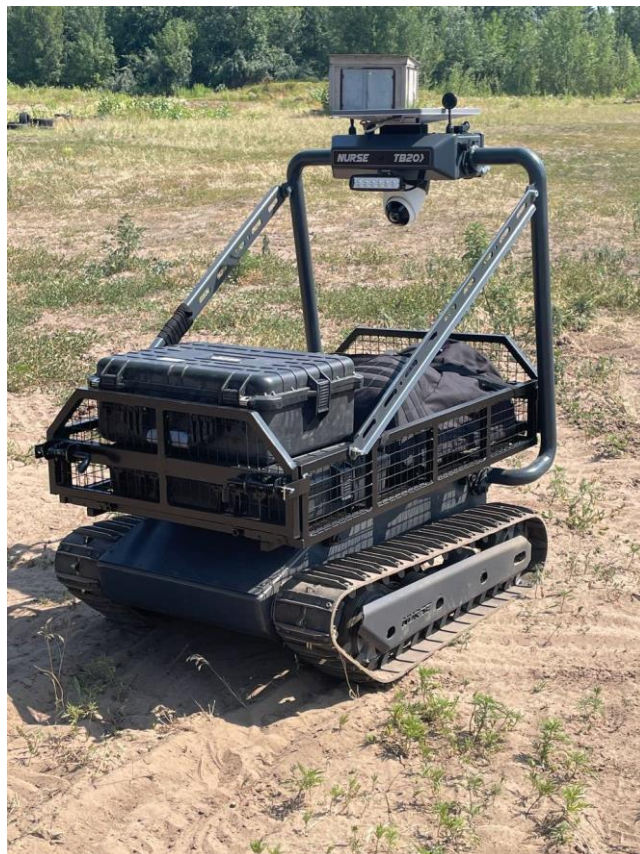
Рисунок 1.1.3. – Роботизований комплекс NURSE TB20 (Логістична платформа)
