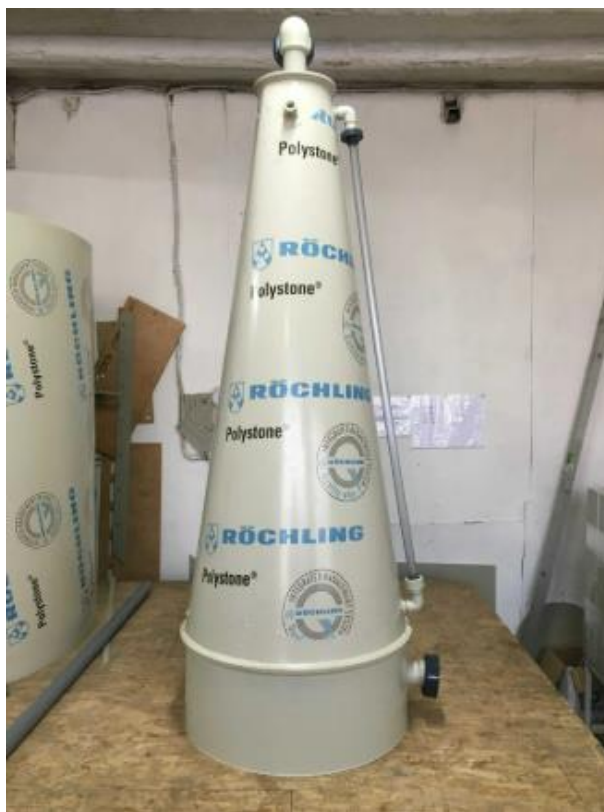
Рис. 3.2.4. Оксигенаторний конус для УЗВ
