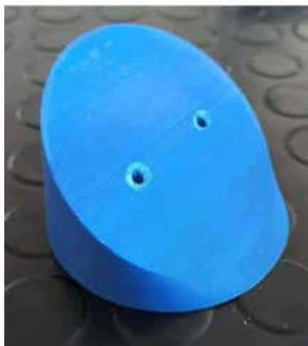
Рис. 3.12 - Результат виготовлення деталі "Нахилена проставка"
