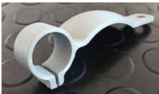
Рис. 3.18 - Результат виготовлення деталі "Кріплення лазера"
