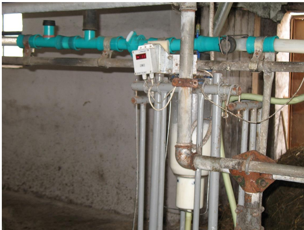
Рис. 3.4. Доїльна установка УДМ-100
