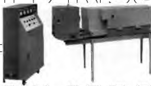
Рисунок 1.6 – Багатоканальний емісійний спектрометр МФС-7 для аналізу мастил.
