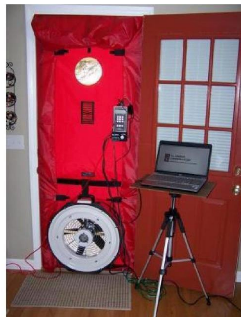
Рис. 2.3. Перевірка герметичності пасивного будинку з Blower-Door Test
