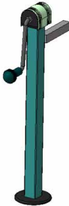
Рисунок 2.6 – Ручний гвинтовий стійковий домкрат
