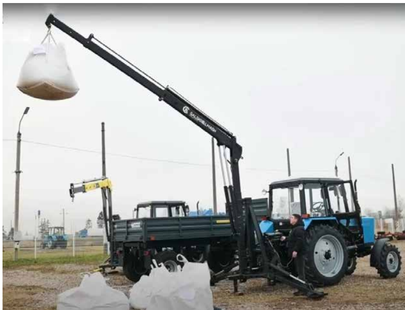
Рисунок 1.2 – Кран-маніпулятор на задню навіску при виконанні навантажувальної операції в сільському господарстві
