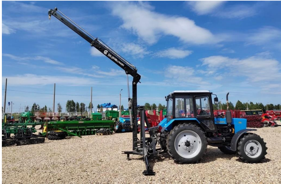
Рисунок 1.1 – Тросовий навісний маніпулятор на базі трактора МТЗ
