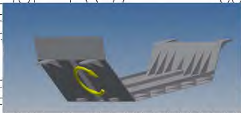
Рисунок 3.17 – Момент, який використовувався для порівняння жорсткості днища зподвійним дном
