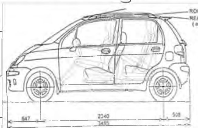
Рисунок 2.4 – Компоновка робочого місця водія та пасажирів Daewoo Matiz Creative 0.8
