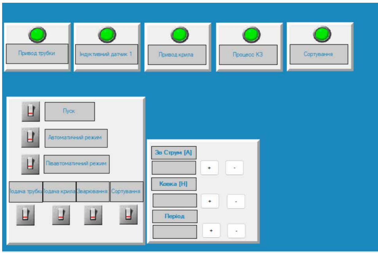
Рис 5.7. Мнемосхема реалізована в середовищі SCADA TRACE MODE
