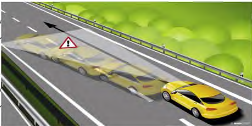
Рис. 2.20 - Система контролю сходу зі смуги руху допомагає запобігти лобовому зіткненню [25].
