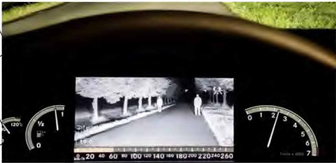
Рис. 2.33 – Система нічного бачення (Automotive night vision) [38].
