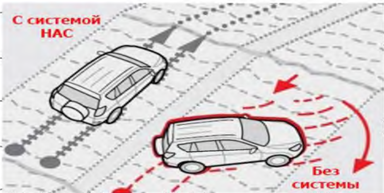
Рис. 2.13 Рух автомобіля із системою НАС та без неї [18].
