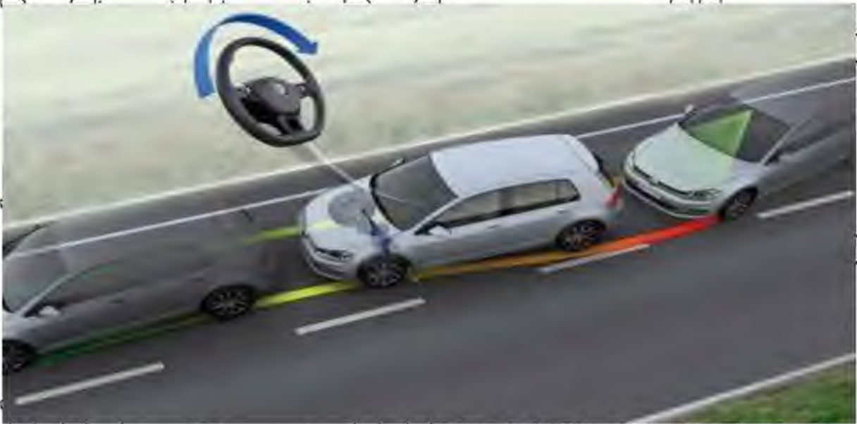
Рис. 2.21 – Система призначена для утримання автомобіля на смузі руху, що має розмітку. [26]
