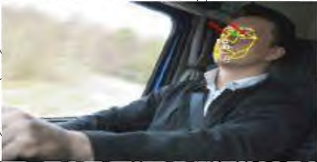
Рис. 2.22 – Система контролю втоми стежить за фізичним станом водія [27].
