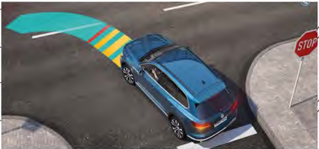
Рис. 2.6 - Надання підтримки при виїзді з зон зі «сліпим» блядом [11].
