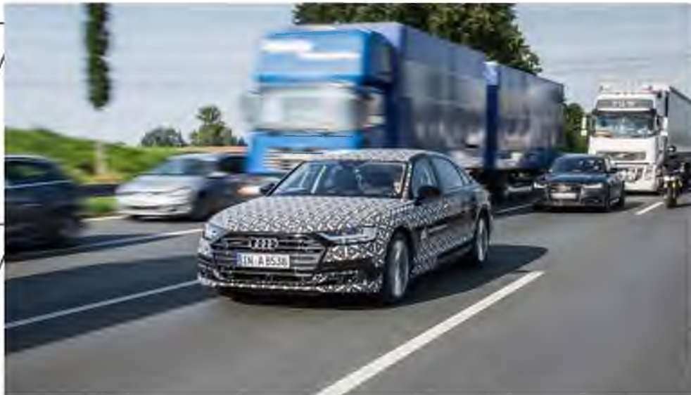
Рис. 2.14 – Помічник руху в пробі керує автомобілем на швидкості до 60 км/год при русі в заторі, щільному потоці [19].
