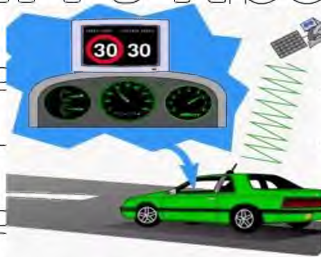
Рис. 2.32 - Система ISA допомагає водію дотримуватися допустимою швидкості руху [37].
