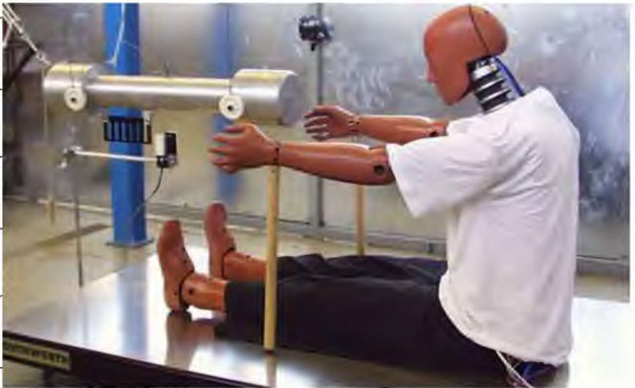
Рис. 3.3 - Голова, шия, груди та ноги манекена оснащені найточнішими датчиками - всього 34 штуки [57].
