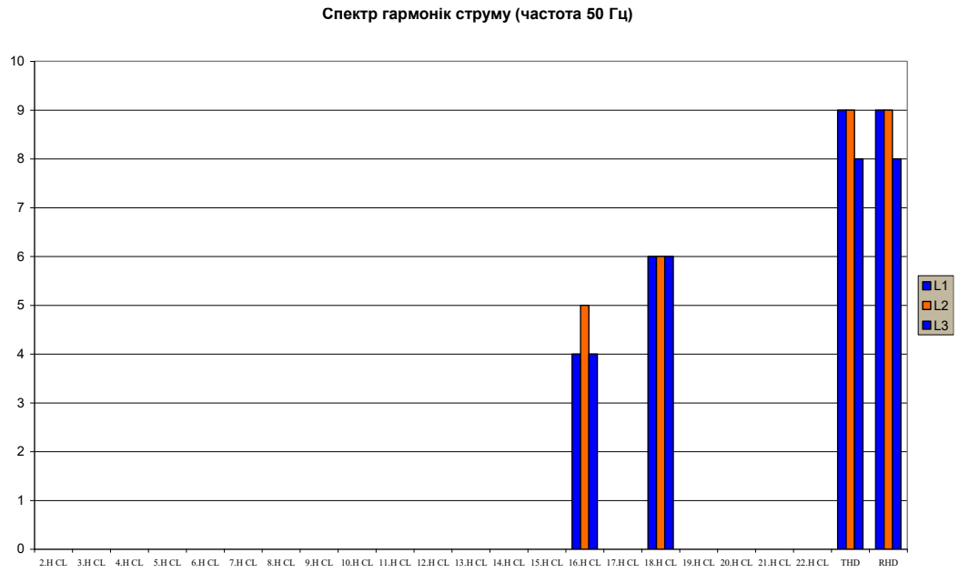
Рис. 4.14. Вищі гармоніки струму перетворювача частоти
