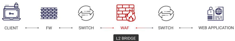
Рисунок 2.2 – Приклад реалізації WAF в режимі моста
