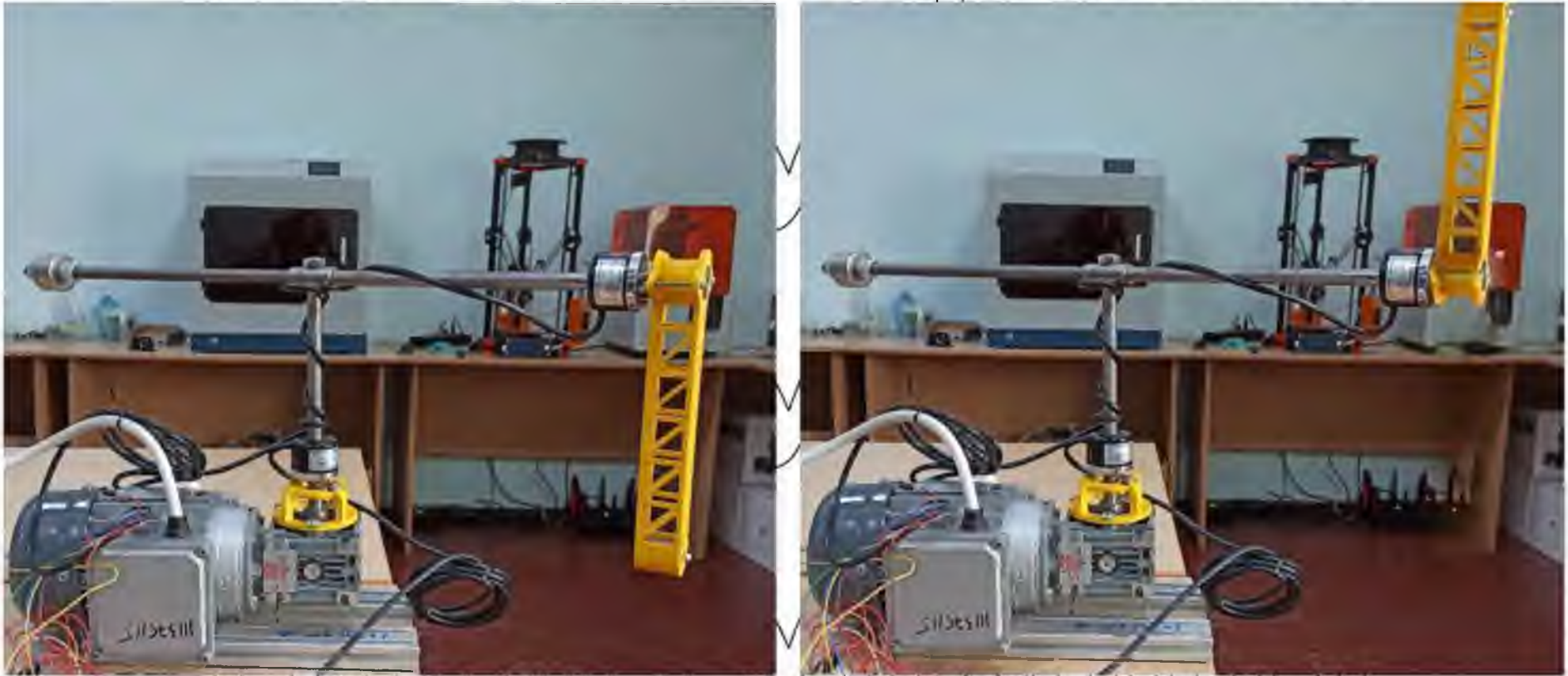
Рис. 3.12. Екпериментальна установка маятника Фурути у початковому положенні (зліва) і у кінцевому положенні маятничової гілки (зправа)
