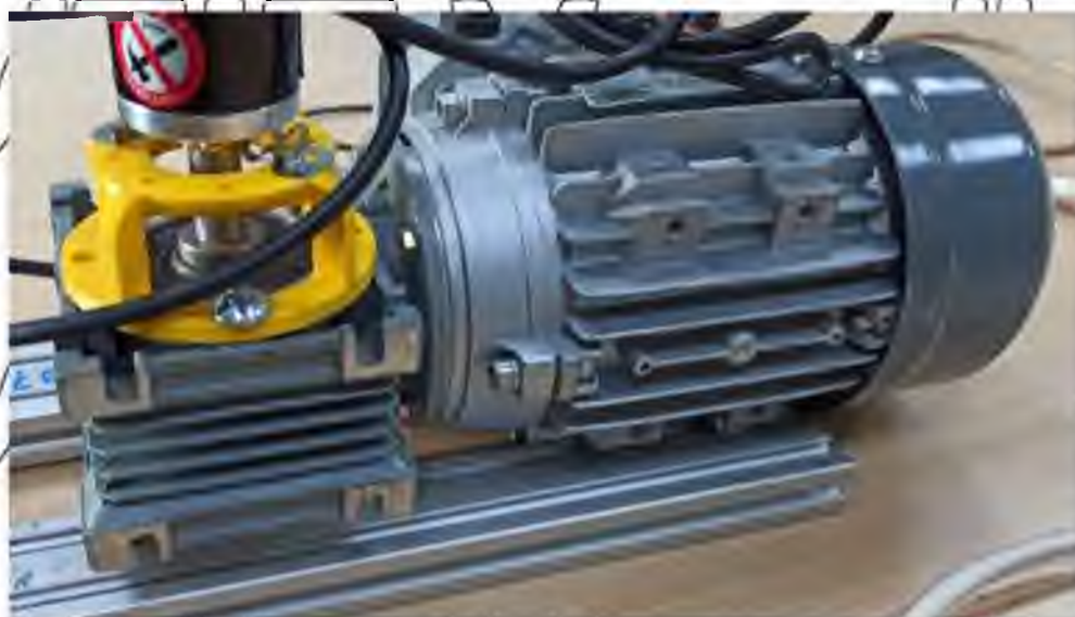
Рис. 3.2 Мотор TECHTOP MS 631-6 B34 (зправа) та редуктор UPM Technologies NMRV 30 (зліва)
