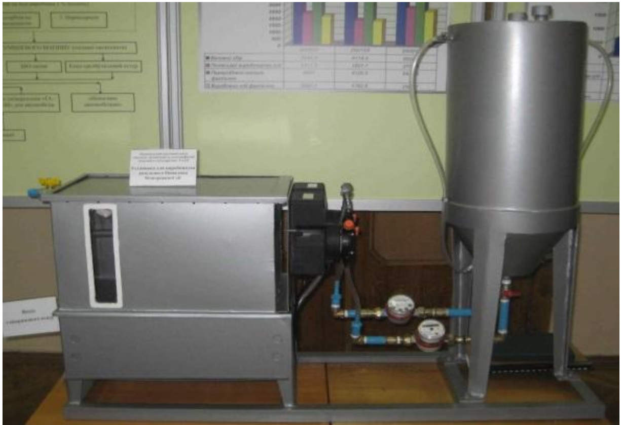
Рис. 2.6. Обладнання для виробництва дизельного біопалива УБ-ТР-20 продуктивність 5 л/год.
