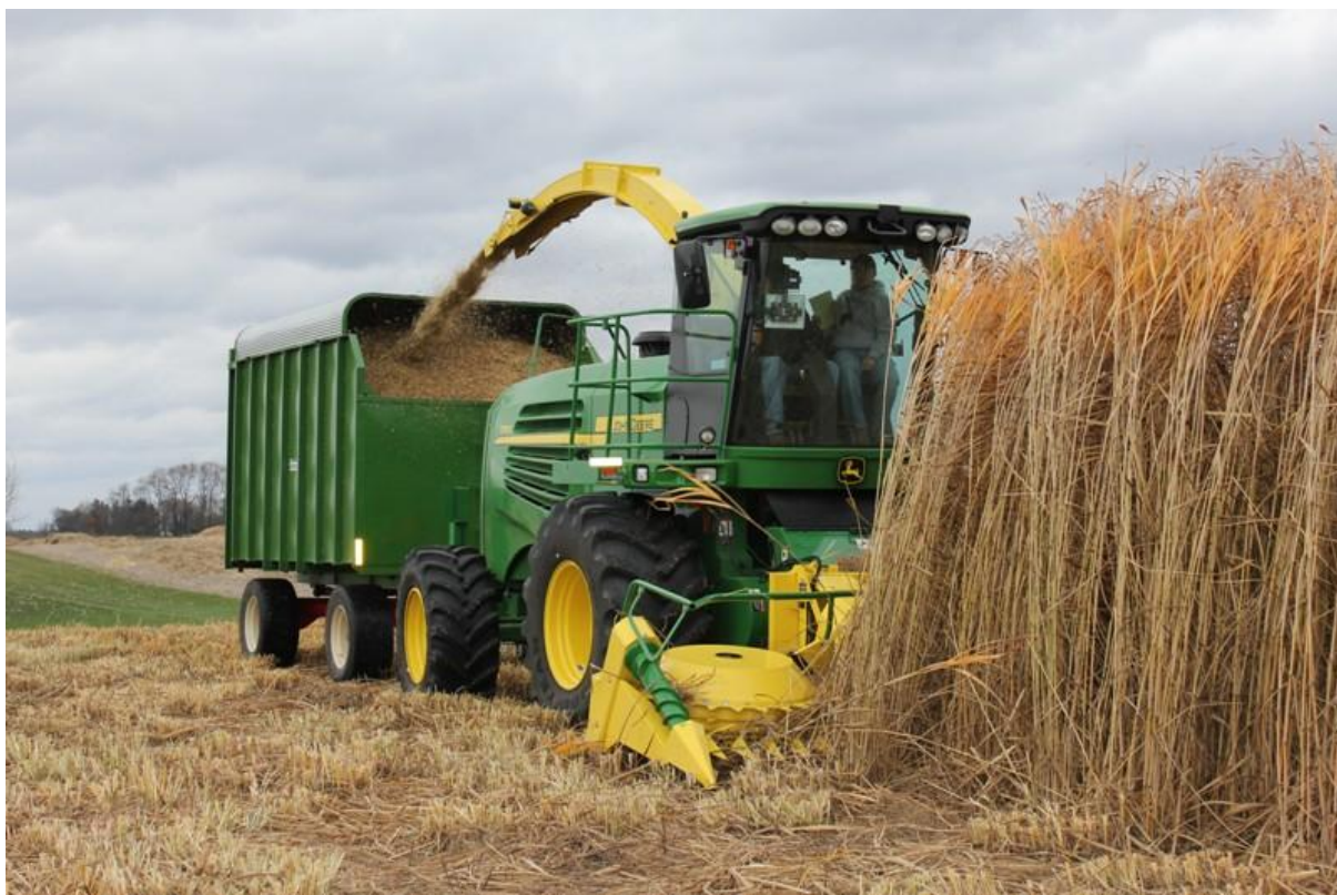
Рис. 10.9. Збирання трав'янистих енергетичних культур кормозбиральним комбайном
