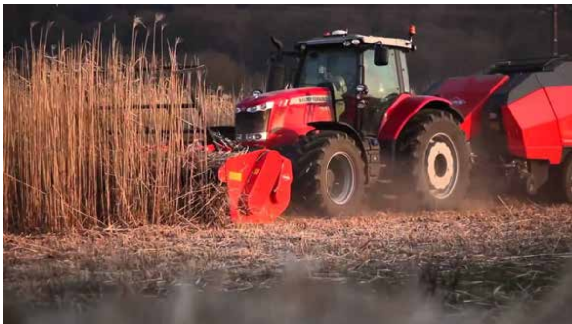
Рис. 10.8. Скошування та тюкування трав'янистих енергетичних культур
