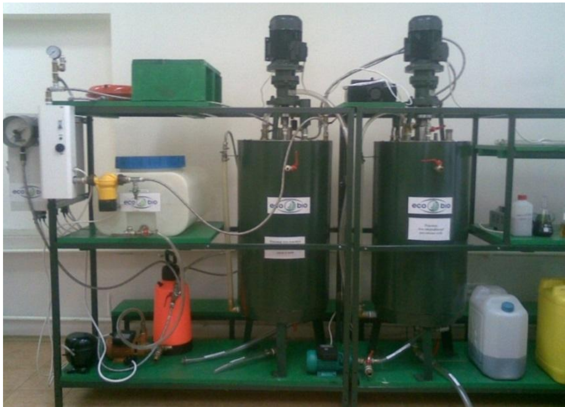
Рис. 2.7. Обладнання для виробництва дизельного біопалива продуктивністю 100 л/год.
