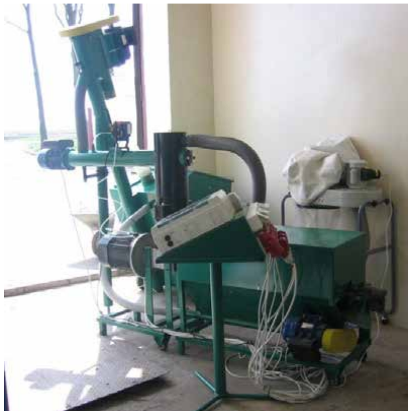
Рис. 9.8. Лінія гранулювання біомаси ЕСО-ВІО-100 виробництва НУБІП (Чехія-Україна)
