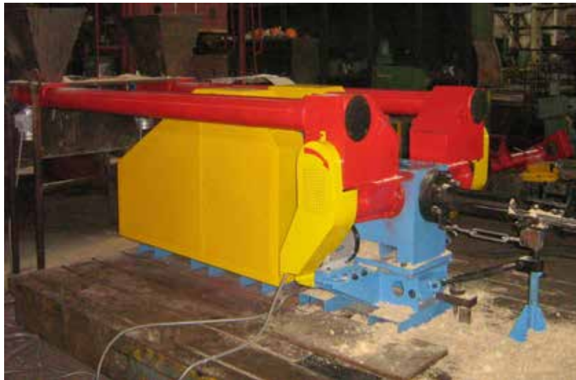
Рис. 9.9. Машина брикетувальна В-80 виробництва ВАТ «Пресмаш» Україна
