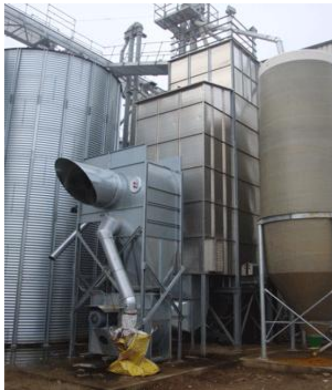
Рис. 7.9. Зернова сушарка із використанням біогазу
