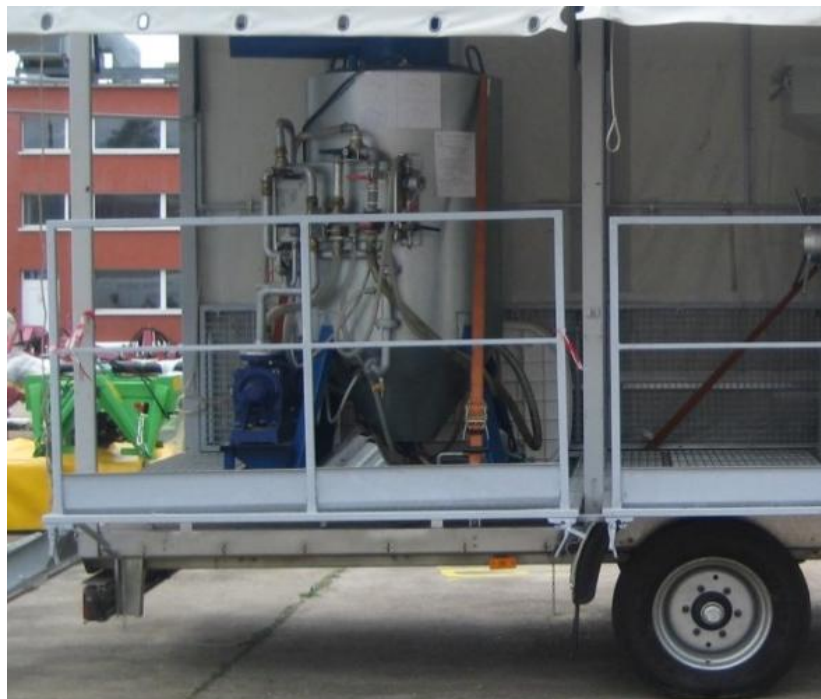
Рис. 2.18. Мобільне обладнання для виробництва дизельного біопалива W500M
