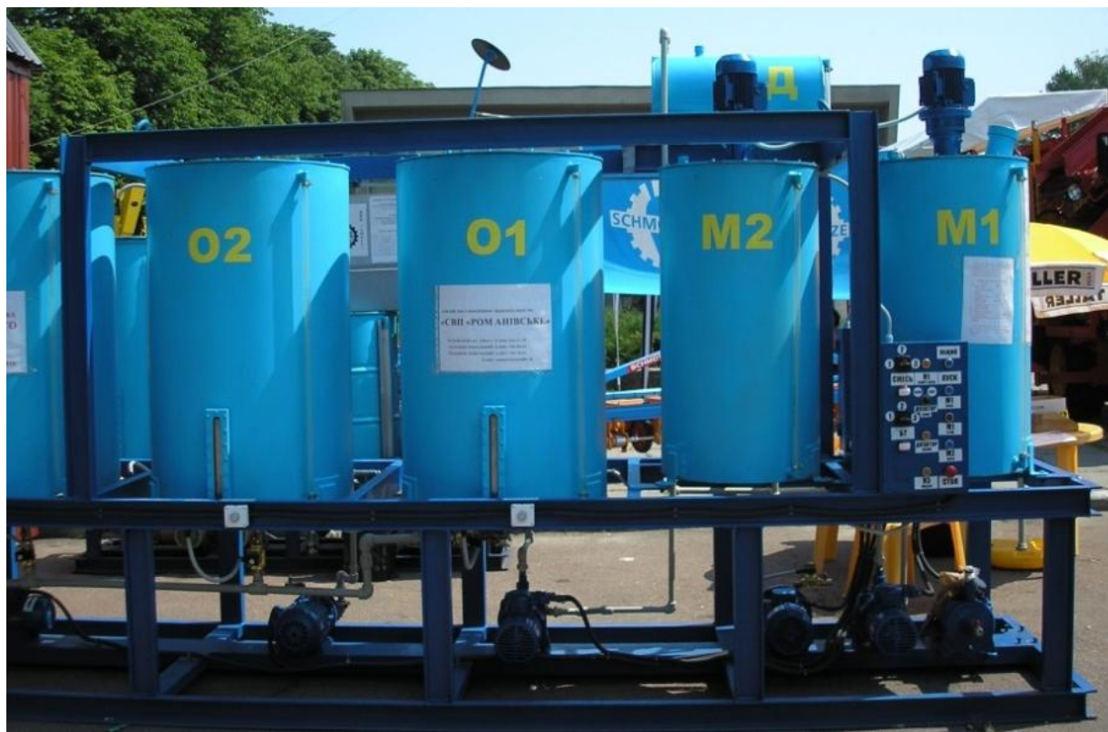
Рис. 2.5. Установка для одержання дизельного біопалива з рослинних олій продуктивністю 1000 т/рік УВМЕ-100
