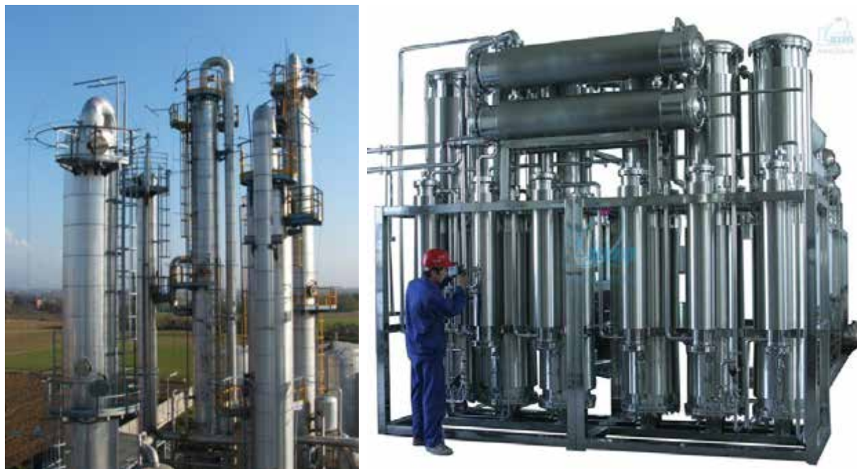
Рис. 4.9. Загальний вигляд ректифікаційної колони та багатоколонного дистилятора
