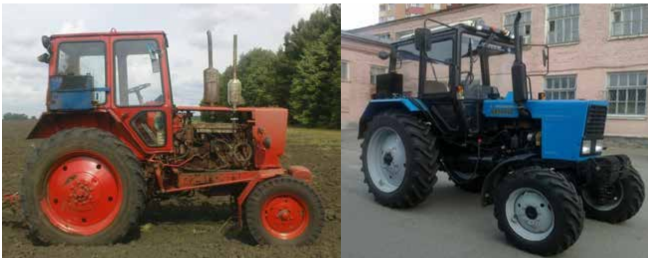
Рис. 3.7. Трактори ПМЗ-6 АКЛ та Кий-14102 обладнані системою двохступеневого підігріву палива
