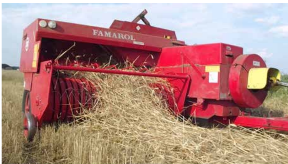
Рис. 9.3. Прес-підбирач поршневого типу для формування малогабаритних тюків, марки FAMAROL Z-511 (Unia Group)
