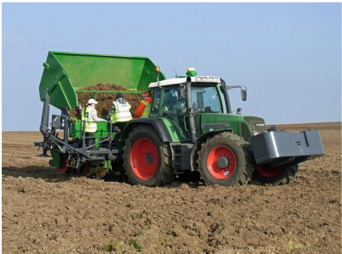
Рис. 10.7. Висаджування кореневищ міскантуса за допомогою картоплесаджалки
