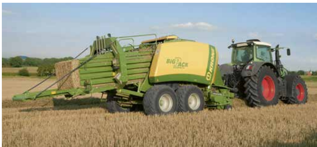
Рис. 9.5. Прес-підбирач поршневого типу для формування тюків середнього та великого типорозмірів, марки Krone "BigPack VFS1290"
