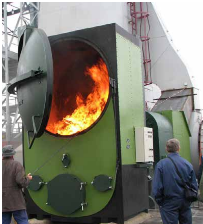
Рис. 9.15. Газогенераторний опалювальний котел для тюків фірми HERLT
