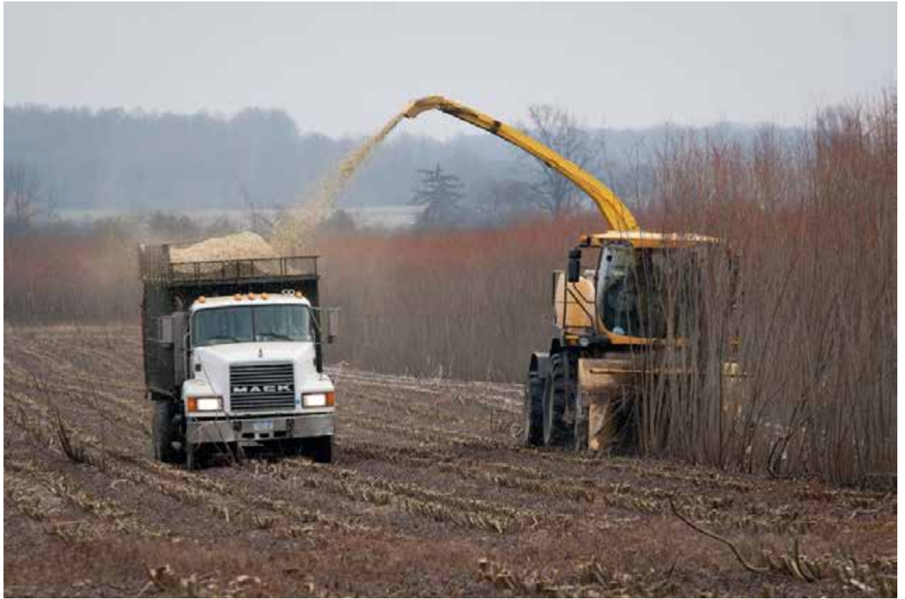
Рис. 10.10. Механізоване збирання деревовидних енергетичних культур
