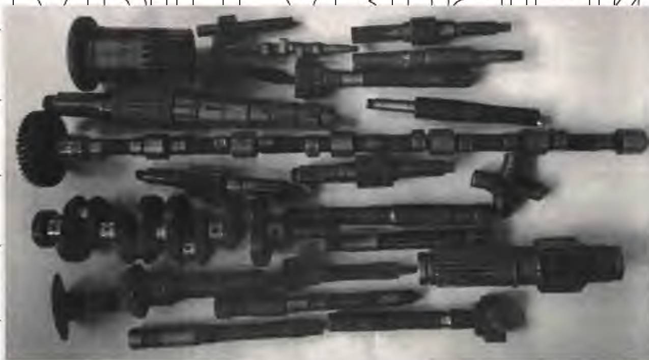
Рис. 5.2. Фотографії деталей, відновлених ЕКН дротом
