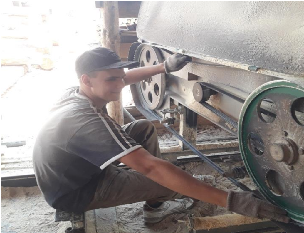
Рис. 3.2. Налаштування горизонтальної стрічкової пилорами
