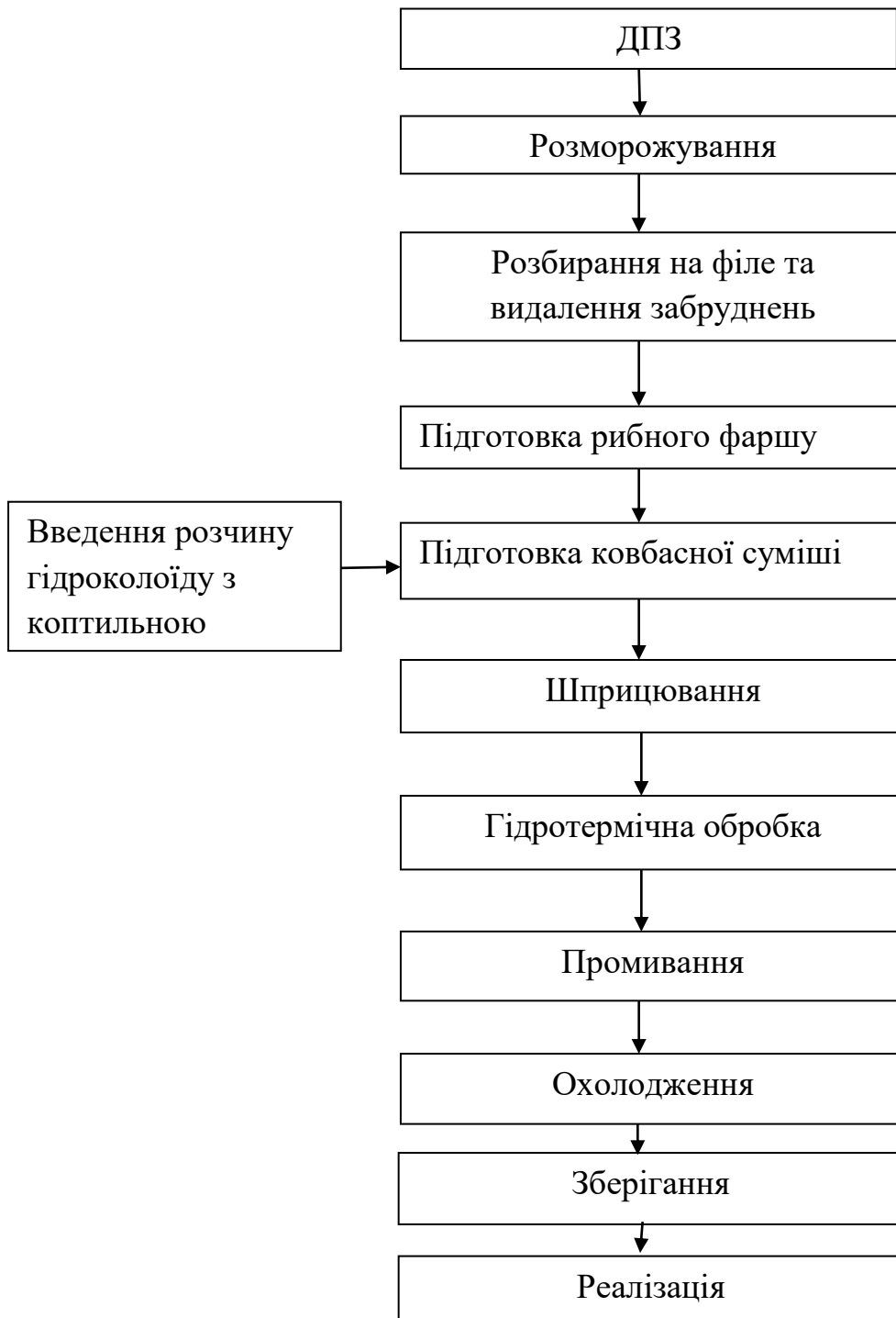
Рис. 3.11. Технологічна схема виробництва рибних ковбас з використанням бездимного копчення
