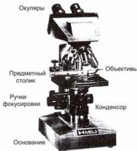
Рис. 20.8. Внешний вид современного микроскопа
