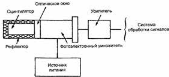
Рис. 30.6. Сцинтилляционный счетчик
