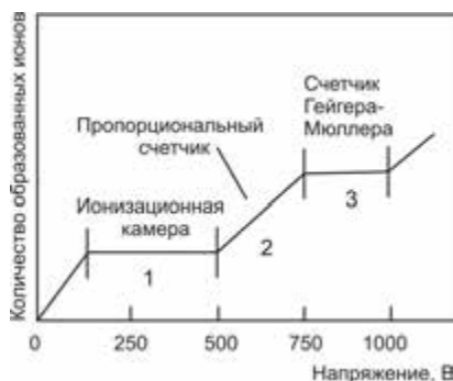
Рис. 30.2. Области действия заполненных газом детекторов:
