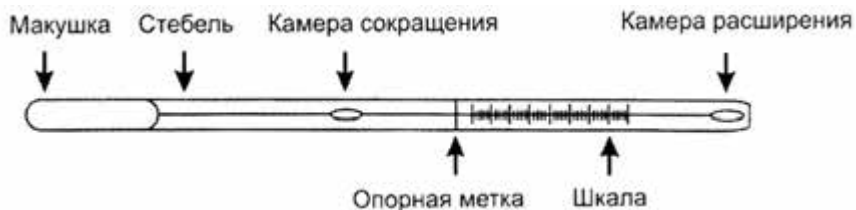
Рис. 8.5. Внешний вид жидкостного термометра
