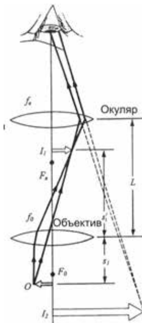
Рис. 20.9. Ход лучей в микроскопе
