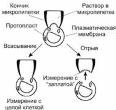
Рис. 11.2. Принцип пэтч-клемп-метода регистрации мембранных токов (пояснения в тексте)
