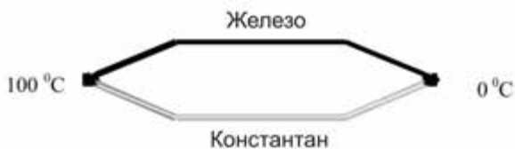
Рис. 8.6. Замкнутая цепь, состоящая из двух разнородных проводников, контакты которых имеют разные температуры
