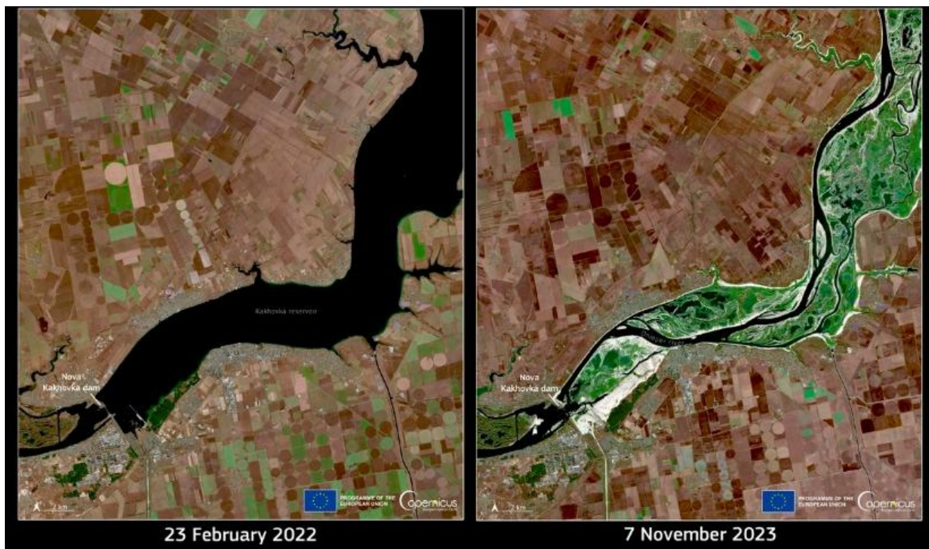
Рисунок 1 - Руйнування Каховської ГЕС (червень 2023) затопило понад 620 км 2 і оголило понад 1000 км 2 дна водосховища.
