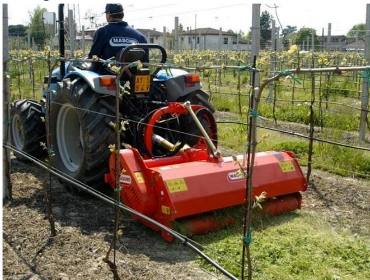
Рис 1.5. – Мульчувач для садів та виноградників Maschio Gaspardo Barbi
