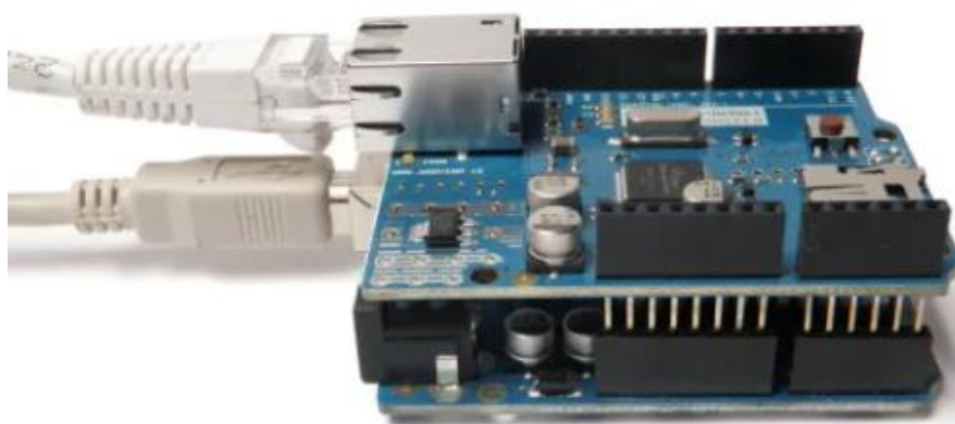
Рисунок 5.10. З'єднання Arduino Mega2560 та Ethernet shield
