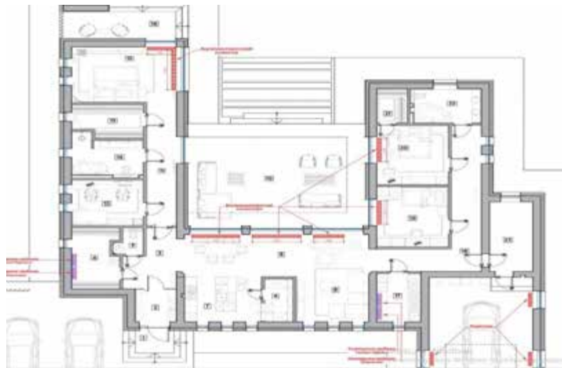
Рис. В.14. розташування внутрішньо підлогових конвекторів
