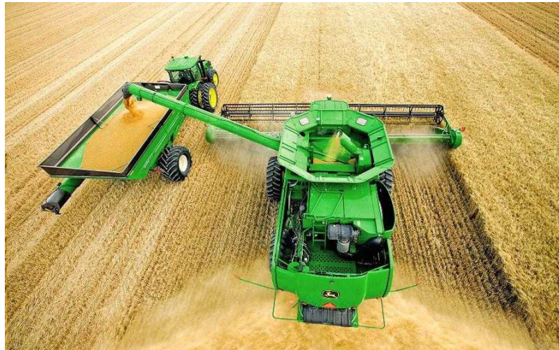
Рис. 4.1. Перевантаження зерна з комбайна у ПБН під час руху з використанням GPS-навігації
