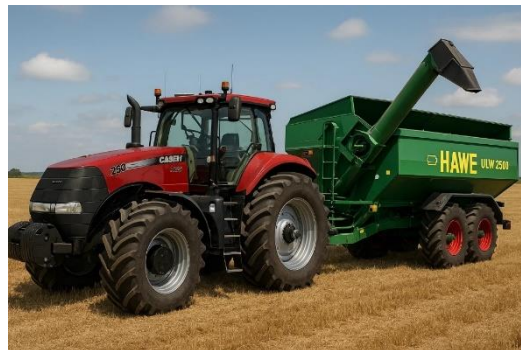
Рис. 3.2. МТА у складі трактора Case IH Magnum 250 і причепа-бункера-накопичувача Hawe ULW 2500
