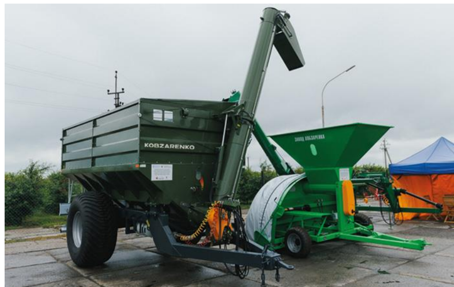
Рис. 4.2. Перевантажувальний бункер-накопичувач (ПБН) у статичному стані перед початком роботи
