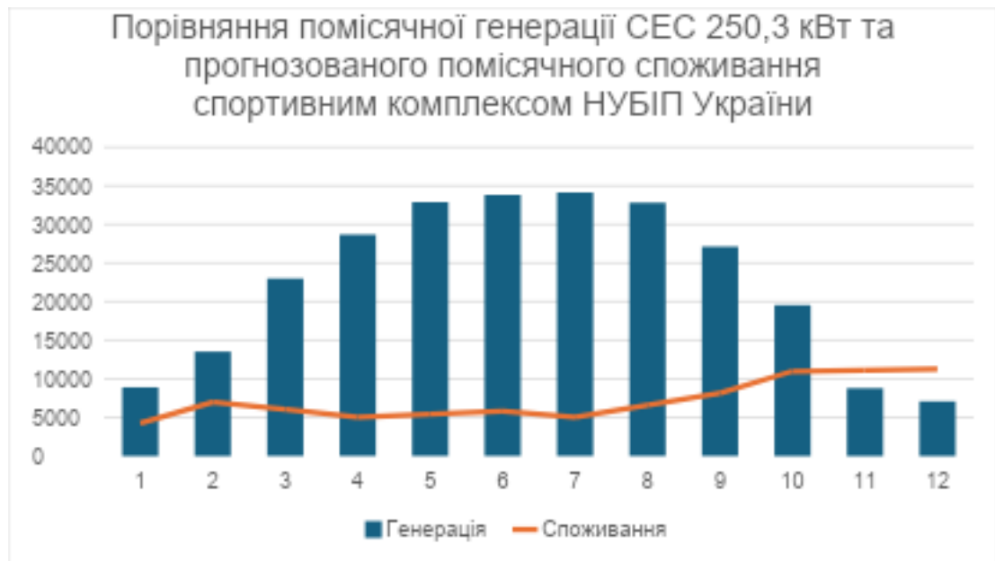
Рис. 3.4. Порівняння помісячної генерації СЕС 250,3 кВт та прогнозованого помісячного споживання спортивним комплексом НУБІП України
