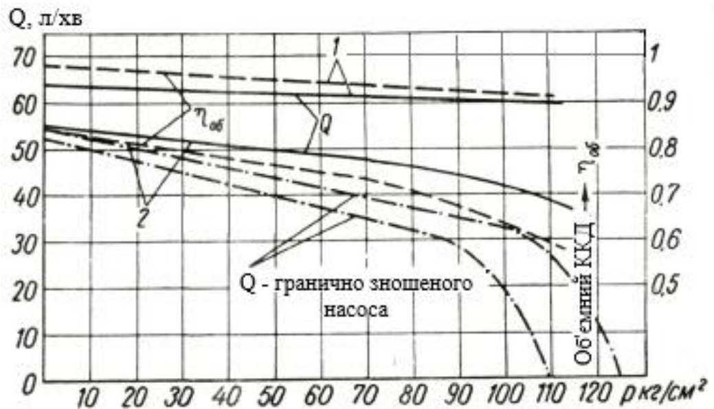
Рис. 1.3. Продуктивність та об'ємний ККД насоса НШ-50 залежно від тиску нагнітання при n = 1300 об/хв ведучої шестерні та різного ступеня зносу.
