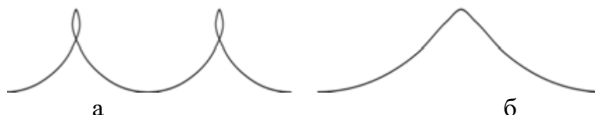
Рис. 4. Траєкторія ножа фрези.
