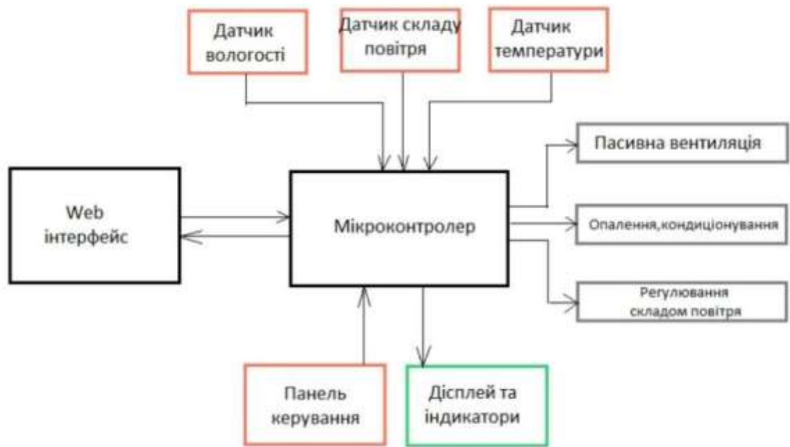
Рис. 3.3 Структурна схема автоматизованою системою контролю мікроклімату корівника.
