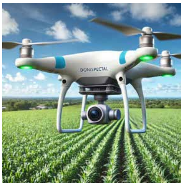
Рис. 1.6. Агродрон, оснащений мультиспектральною камерою для моніторингу стану кукурудзи.
