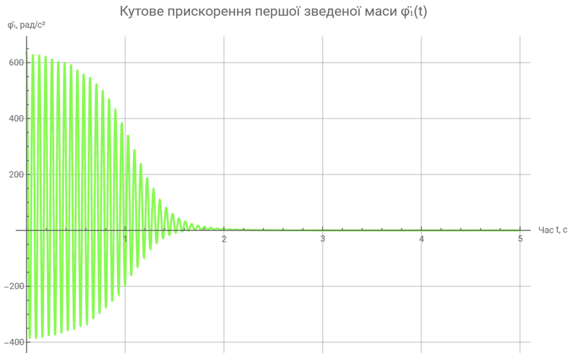
Рис. 3.6. Графік кутового прискорення першої зведеної маси динамічної моделі пневматичного конвеєра
