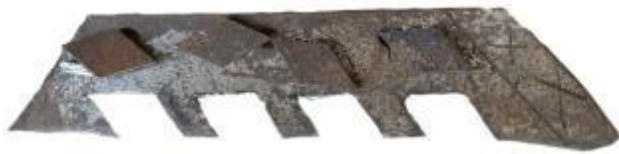
Рисунок 3 – Поверхня лемішу з вирізами під вставки
