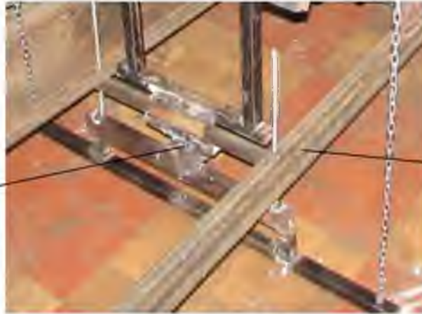
Рис. 3.4 – Шарнірне з'єднання елементів експериментальної установки 1 – шарнір коливання; 2 – рама остова
