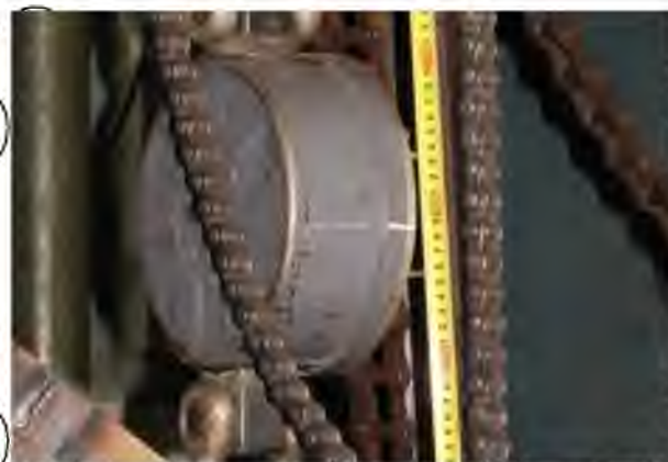
Рис. 3.10 – Вимір висоти підйому передньої частини машини
