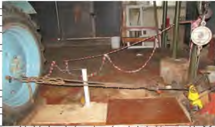
Рис. 3.14 - Пристосування для визначення бічної деформації шин
