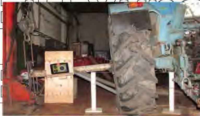
Рис. 3.13 - Визначення деформації шини
