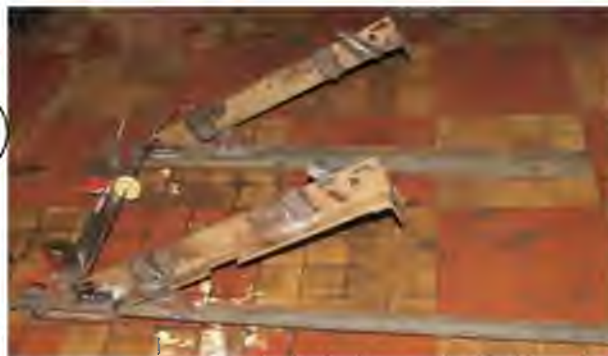
Рис. 3.5 – Пристосування для підйому передньої частини трактора
