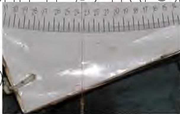
Рис. 3.9 - Пристосування для вимірювання кута нахилу машини
