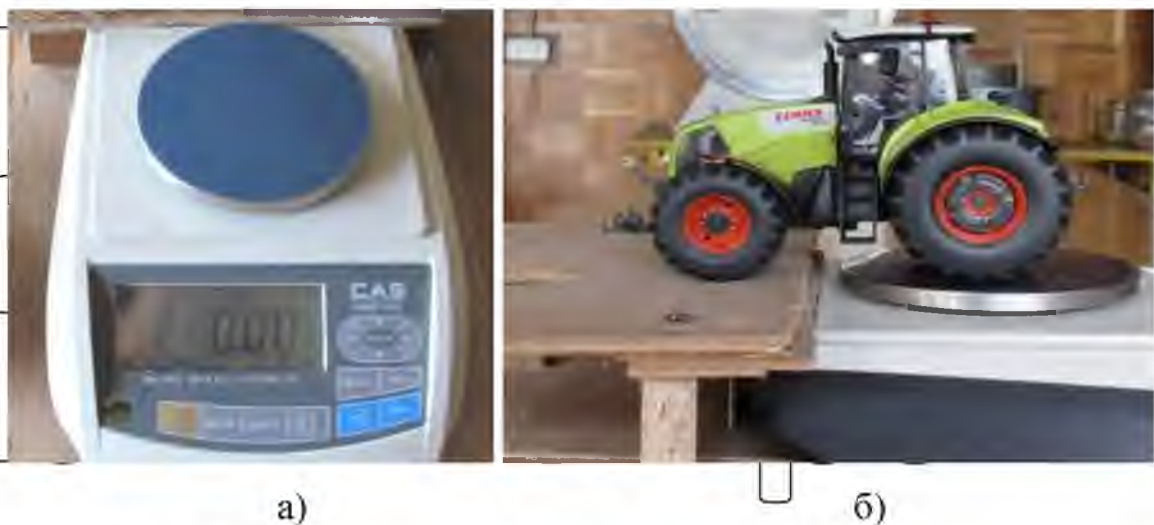
Рис. 3.18 - Устаткування для визначення маси моделей:
