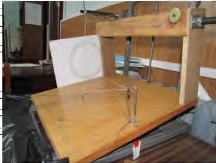
Рис. 3.19 - Установка для визначення кута статичної стійкості моделей
