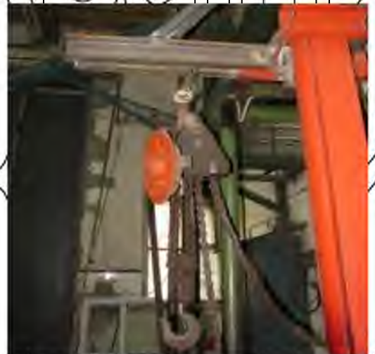
Рис. 3.7 - Черв'ячна таль: а - параметри; б - закріплення на балці
