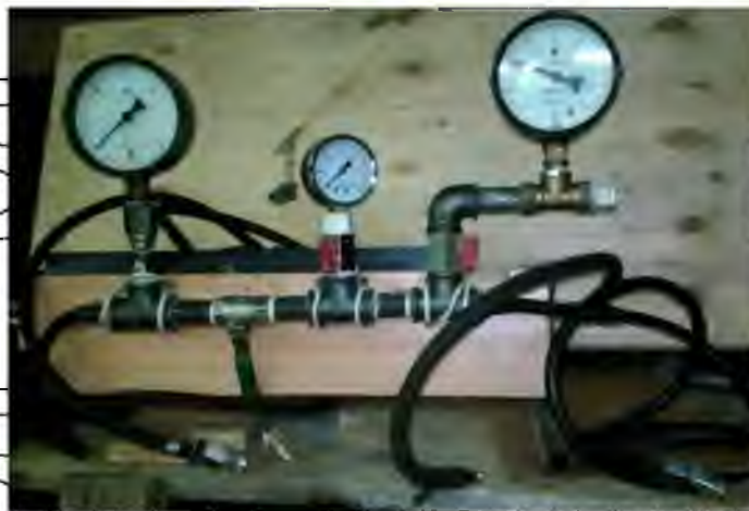
Рис. 3.16 - Пристосування для накачування шин
