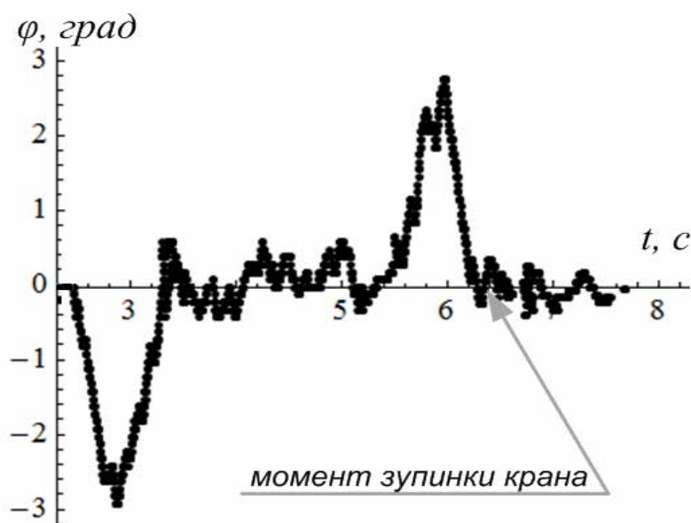
Рис. 6.5. Графік кута відхилення канату з вантажем від вертикалі при русі крана за кінематично-динамічним законом
