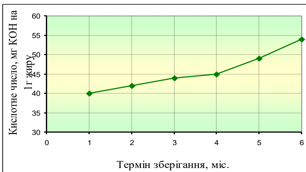
Рис.3.7. Динаміка показників кислотного числа при зберіганні кормових добавок за температури навколишнього середовища
