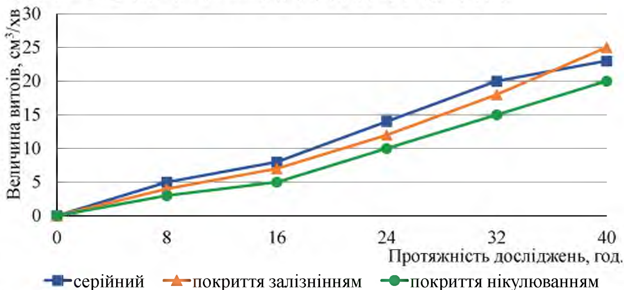
Рисунок 4.11 Величина витоків внаслідок стендових випробувань золотникової пари.
