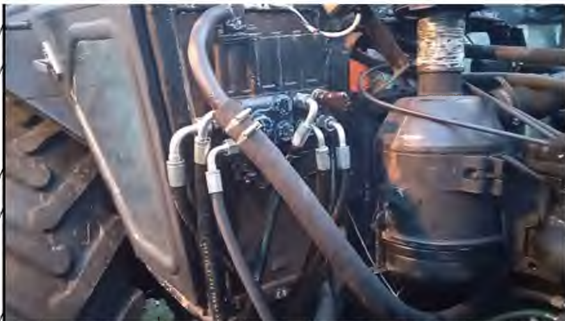
Рисунок 4.12 Гідроподільник Р80 із золотниками, відновленими ультра- та наноконпозиційним нікелюванням, при експлуатаційних випробуваннях.
