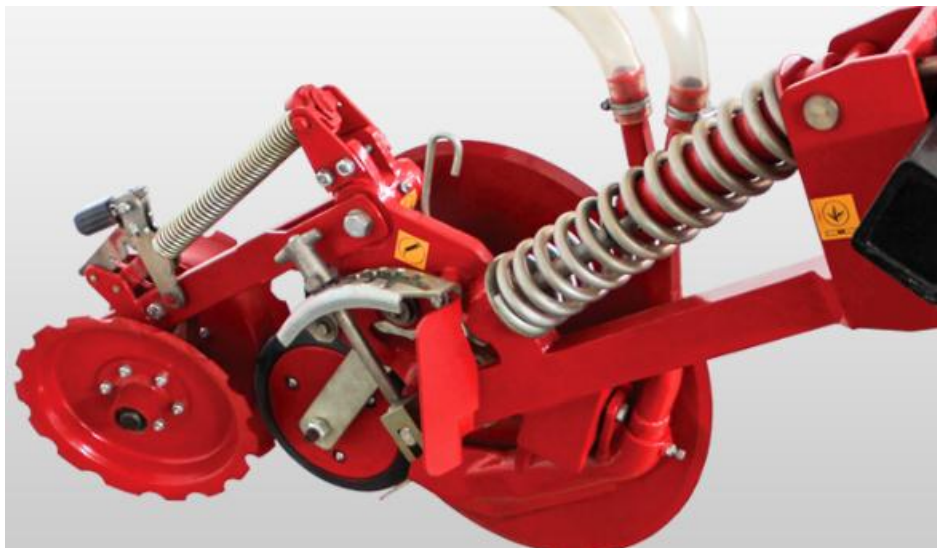
Рисунок 1.2 – Радіальні механізми копіювання з притискними пружинами: а – John Deere 1830-1895; б – Orion - 9,6.
