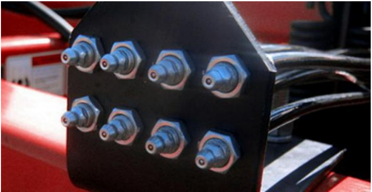
Рисунок 1.4 – Пункт системи централізованого мащення (вручну) посівного комплексу виробництва Versatile
