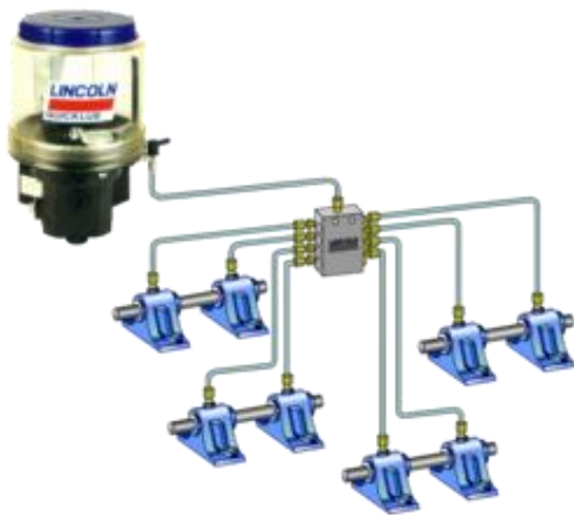
Рисунок 1.5 – Централізована еkleктична система мащення: а – схематичне зображення компонентів системи, б – ємність із мастилом та система розподілення мастила виробництва Amazone
